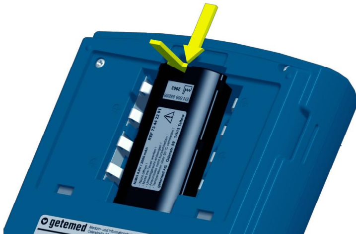
Abb. 10 Pfeile zeigen die Einlegerichtung des Blockakkus.
