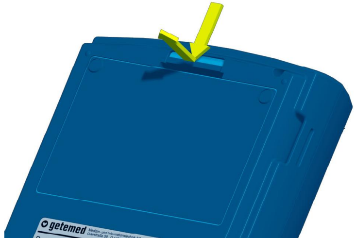
Abb. 8 Verriegelung des Batteriefachs lösen
