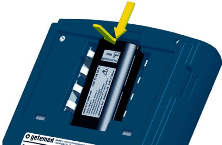
Abb. 10 Pfeile zeigen die Einlegerichtung des Blockakkus.
