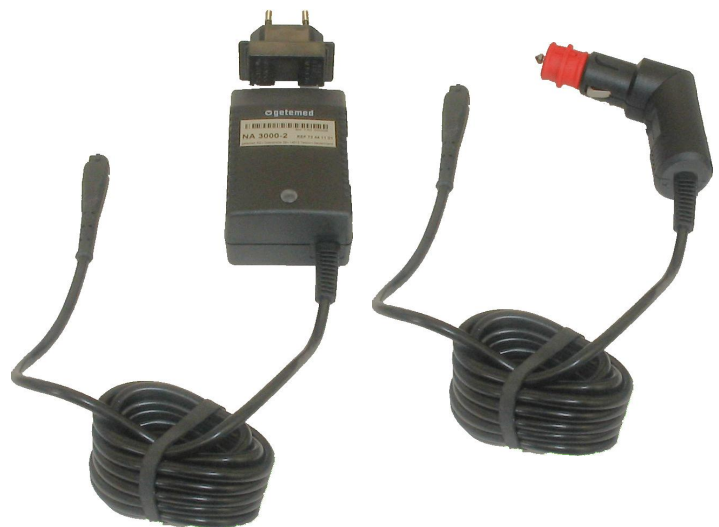
Abb. 7 Netzadapter für 230 V-/50 Hz-Stromversorgungsnetz und Kfz-Bordnetz
